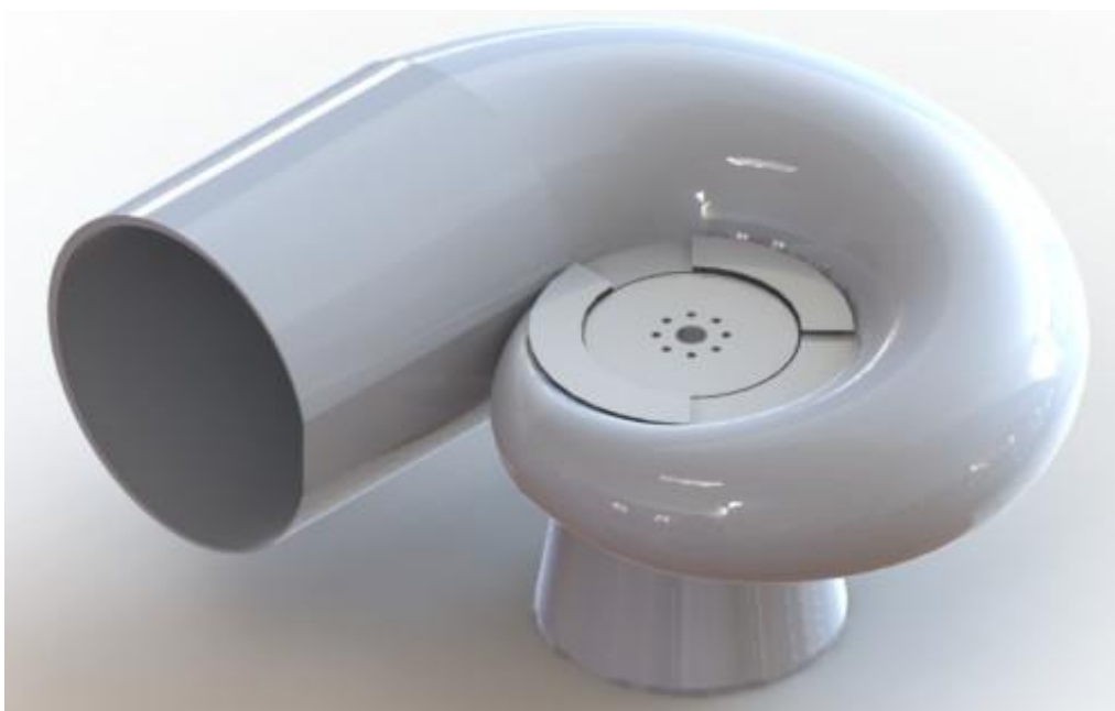
Figura 14: Vista isométrica da turbina Francis.
