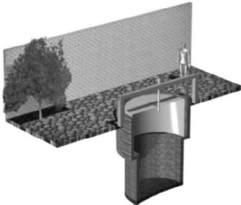
Figura 5: Biodigestor do tipo Batelada. Fonte: Oliveira, 2009
