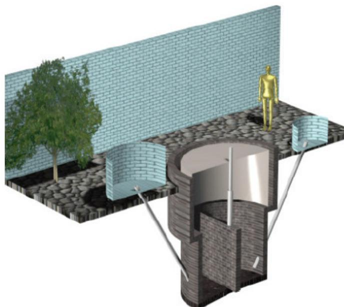
Figura 2: Biodigestor modelo Indiano. Fonte: França Jr. 2008.
