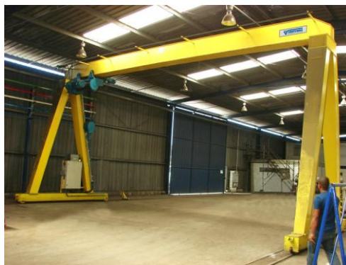
Figura 3 - Exemplo de pórtico monobloco ou univiga.
