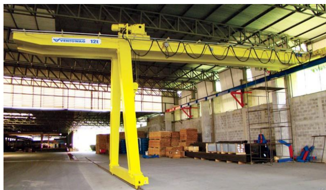
Figura 5 - Exemplo de Semi-pórtico.
