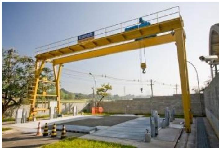
Figura 4 - Exemplo de pórtico rolante de dupla-viga.
