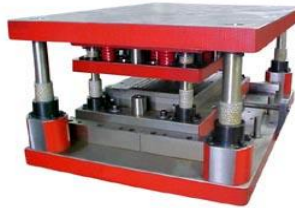
Figura 4: Estampo de corte, dobra e repuxo.
