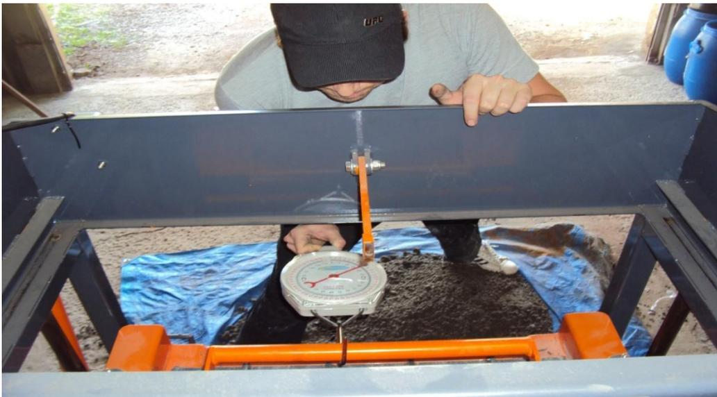
Figura 18: Dinamômetro usado para medição da força realizada para o deslocamento do carrinho.
