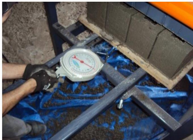
Figura 21: Operação executada para medição da força realizada para o deslocamento do palhete.
