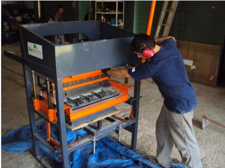
Figura 12: Segunda etapa de trabalho da máquina para produção de blocos de concreto.
