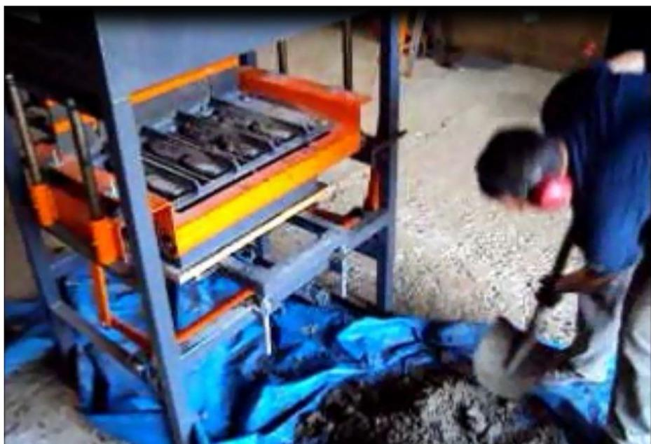
Figura 11: Primeira etapa de trabalho da máquina para produção de blocos de concreto.
