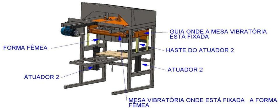
Figura 16: Posição dos atuadores 2 na máquina de bloco.
