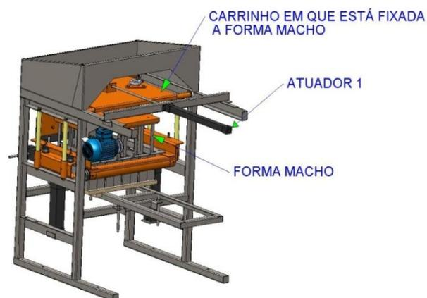
Figura 15: Posição do atuador 1 na máquina de bloco.
