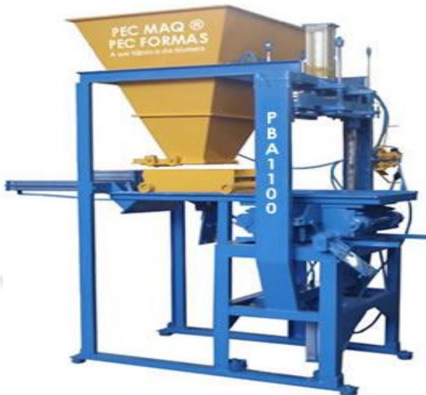
Figura 1: Máquina para produção de blocos de concreto. Fonte: Pec Formas, 2012.
