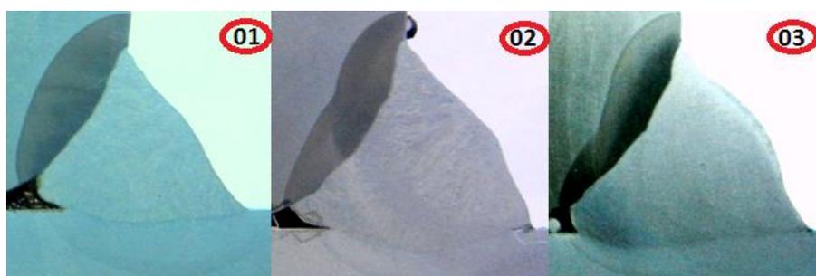
Figura 10: Macrografia dos corpos de prova soldados sem pré-aquecimento e sem pós-aquecimento. (01) Um cordão de solda, (02) dois cordões de solda e (03) três cordões de solda.
