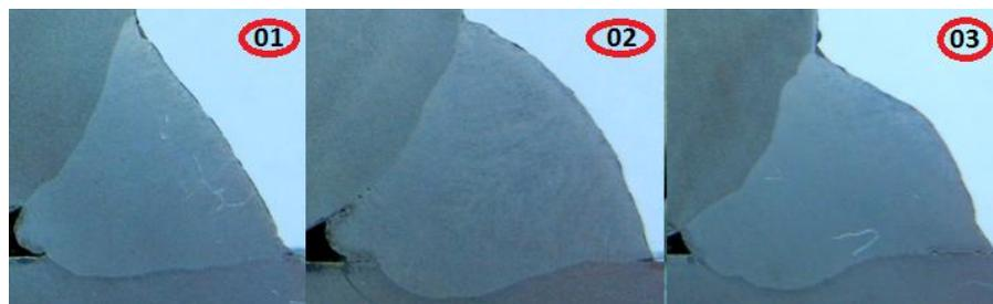
Figura 40: Macrografia dos corpos de prova soldados com pré-aquecimento e pós-aquecimento. (01) Um cordão de solda, (02) dois cordões de solda e (03) três cordões de solda.
