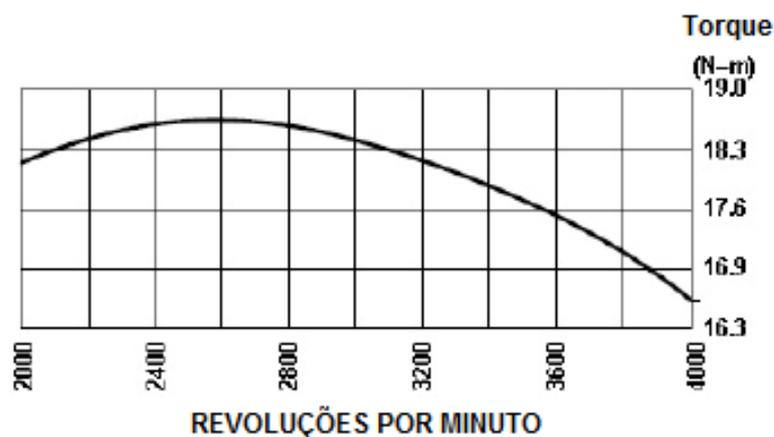
Figura 12: Curva de torque do motor Briggs & Stratton 10HP. Fonte: Sousa *apud* Briggs & Stratton, 1999.
