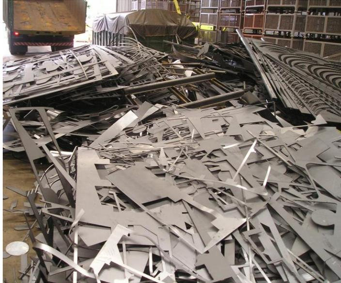
Figura 1: Material separado pronto para prensagem. Fonte: Autor.
