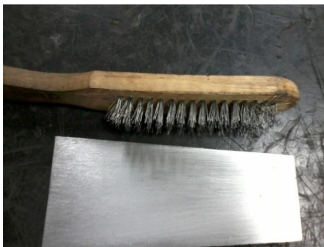
Figura 12: Preparação do substrato.
