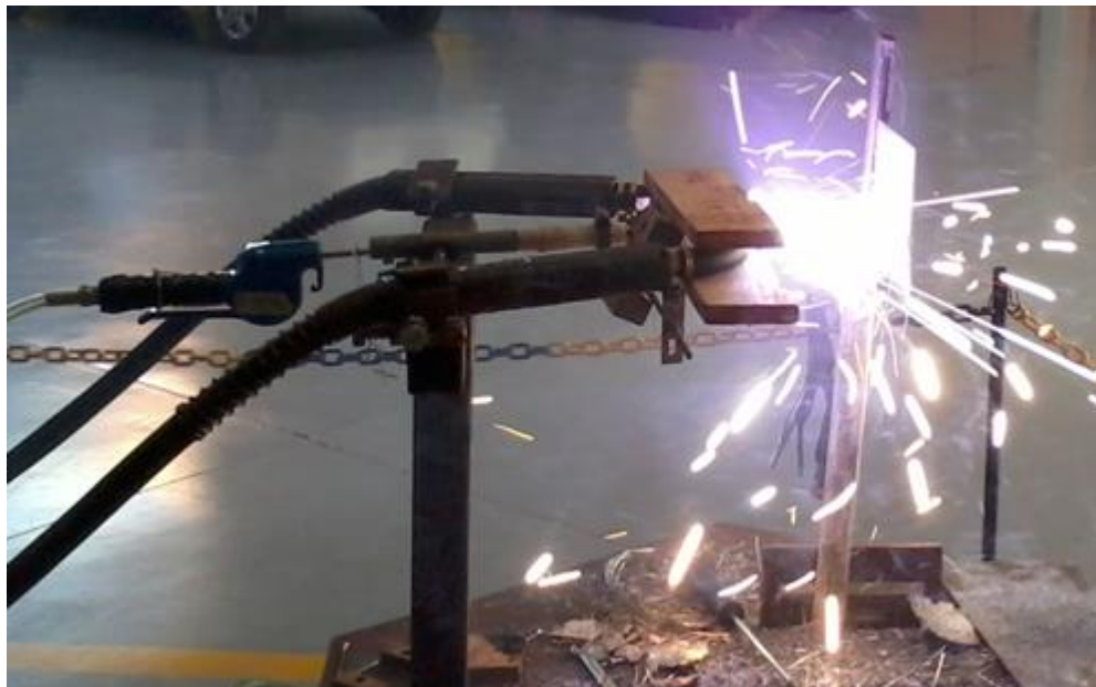
Figura 18: Equipamento de aspensão térmica em funcionamento.
