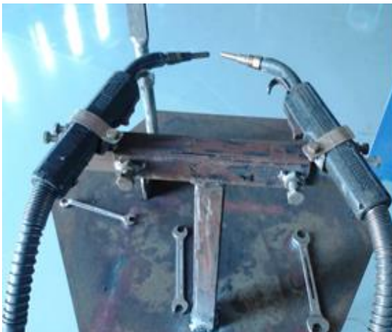
Figura 11: Tochas montadas no dispositivo de aspersão.
