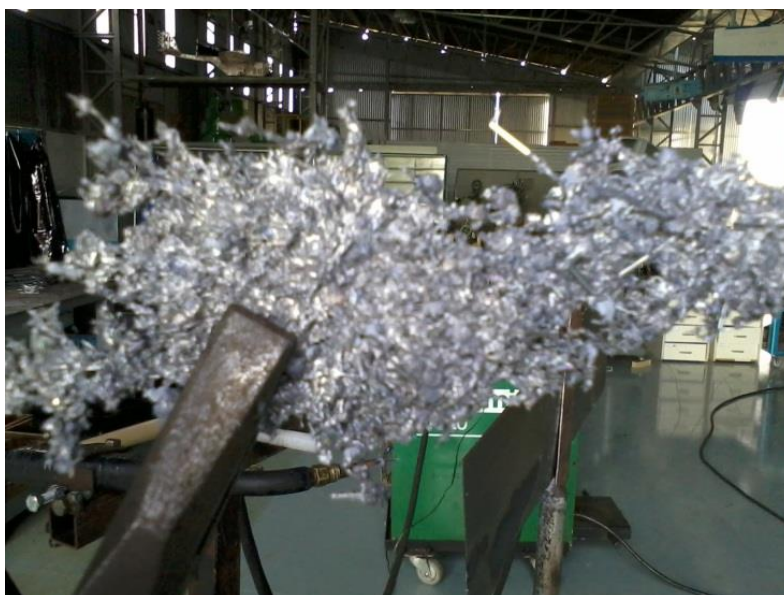
Figura 16: Revestimento sem aderência retirado do substrato.
