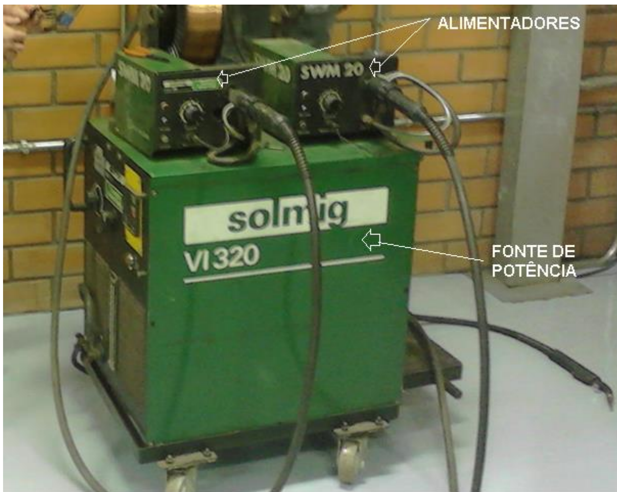
Figura 7: Fonte de potência e alimentadores utilizados no processo de aspersão.
