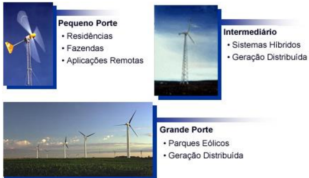
Figura 3 - Características e aplicações de aerogeradores
