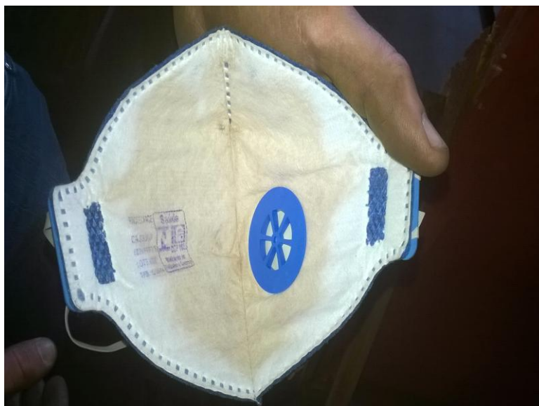
Figura 12 – Máscara com fumos absorvidos.
