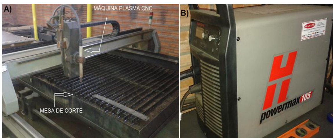
Figura 8 – CNC de corte plasma e fonte de potência.
