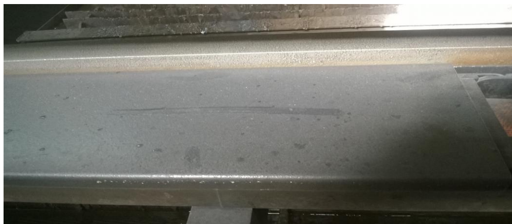
Figura 13 – Acumulo de micropartículas na superfície.
