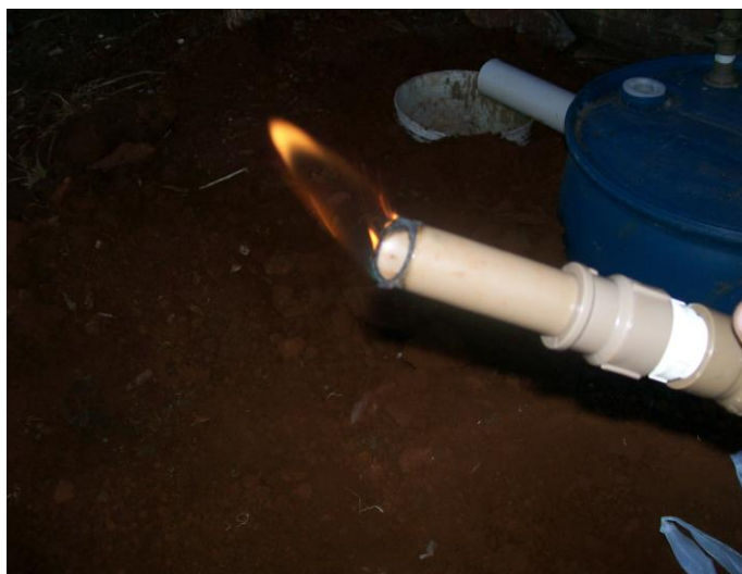
Figura 19 – Biogás sendo queimado
