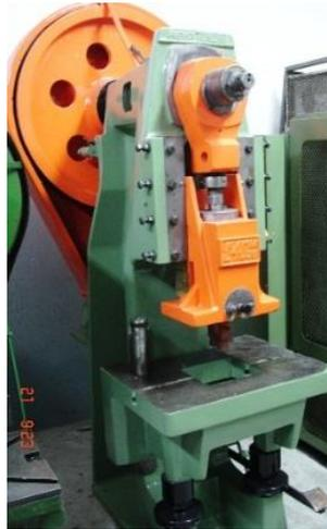
Figura 6: Prensa mecânica excêntrica de engate por chaveta.
