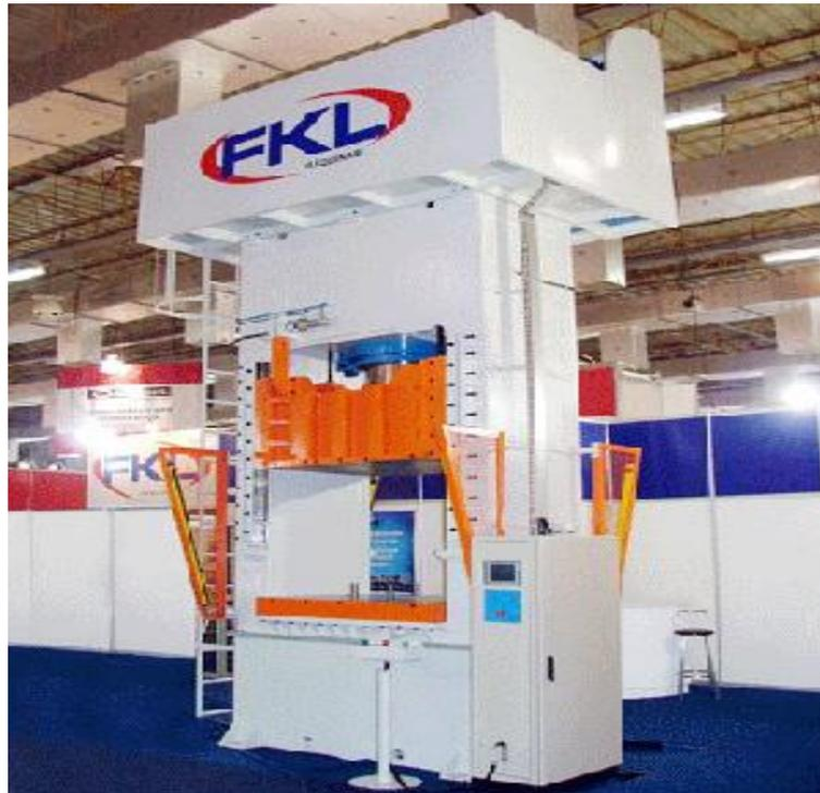
Figura 15: Prensa hidráulica.
