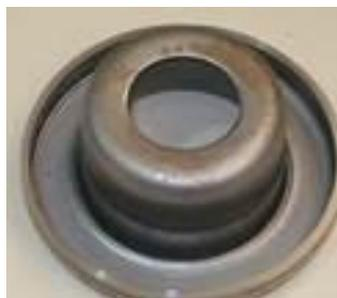
Figura 4: Peça cortada e embutida.
