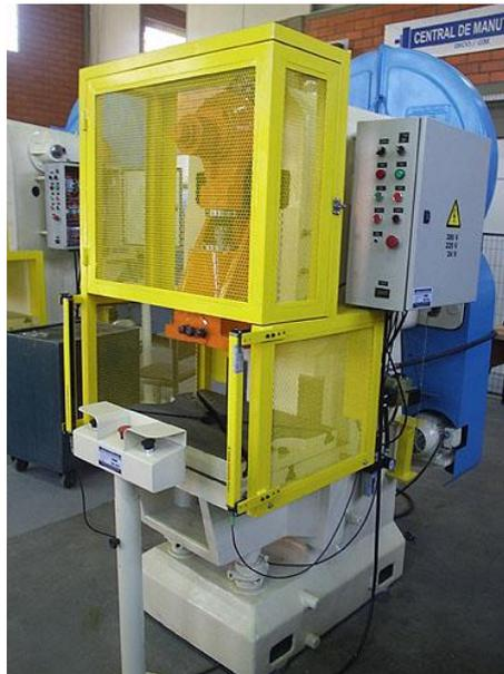
Figura 14: Prensa excêntrica pós retrofitting.
