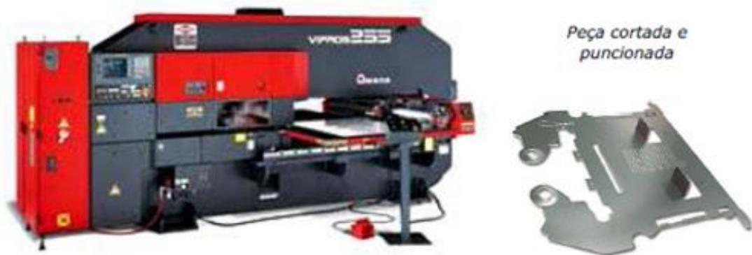
Figura 16: Puncionadeira e exemplo de peça.
