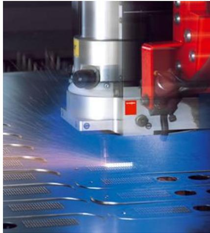
Figura 17: Exemplo de corte a laser de chapa metálica.
