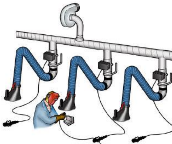
Figura 6: Instalação centralizada para captação de fumos metálicos e gases de soldagem. Fonte: Nederman, 2015.
