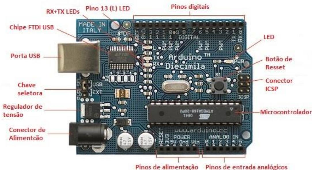
Figura 8: Placa Microcontroladora Arduino Diecimila. Fonte: Arduino
