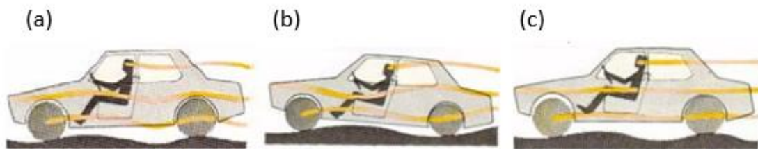
Figura 2: Situações de suspensão. (a) ausência de suspensão, (b) ausência de amortecimento e (c) suspensão eficiente. Fonte: Costa, 2002.
