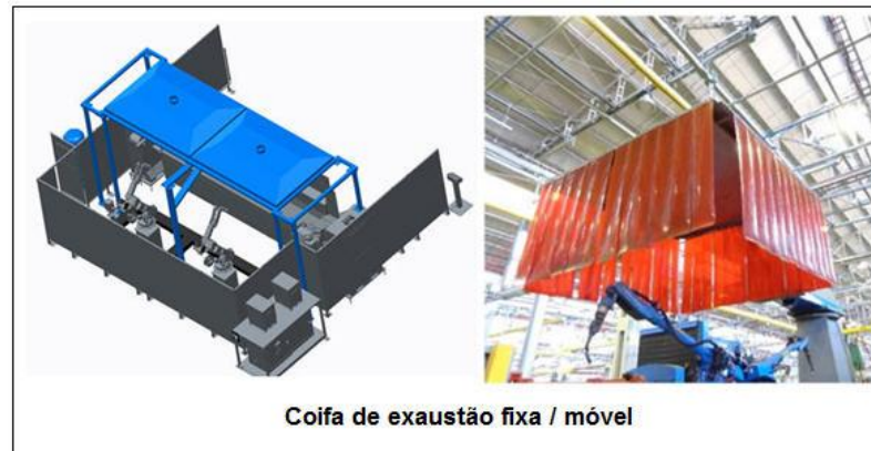
Figura 19 – Proposta de coifa de exaustão da célula robotizada.
