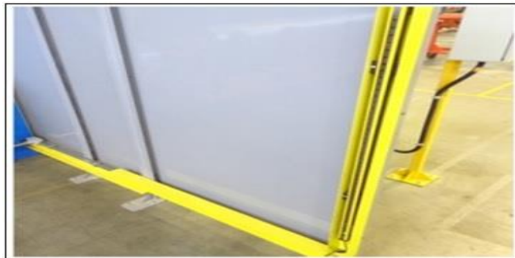
Figura 6 – Proposta de cortinas de luz horizontal e vertical da célula robotizada.
