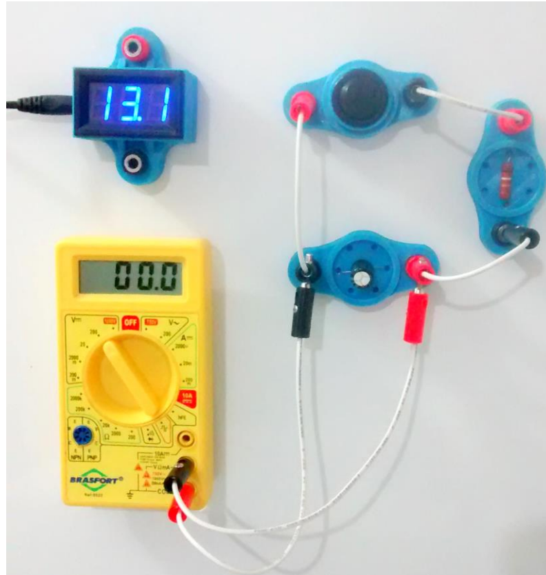
Figura 41: Circuito de descarga do Capacitor na Bancada
