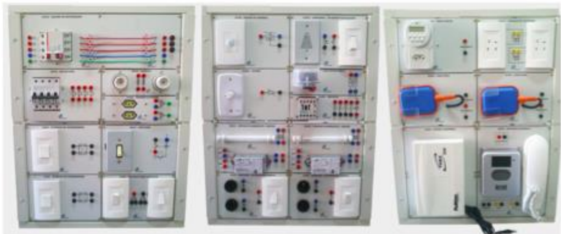
Figura 1: Bancada Didática em de Instalações Elétricas Residenciais. Fonte: Algetec (s.d.)
