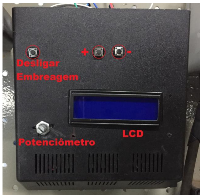
Figura 21 - Caixa de acabamento com os componentes
