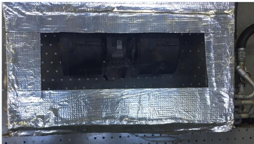
Figura 17- Implementação da nova caixa de isolamento
