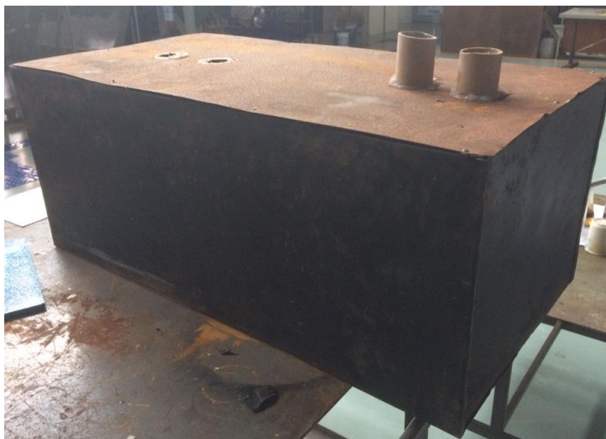
Figura 13- Caixa de reservatório do ar refrigerado.
