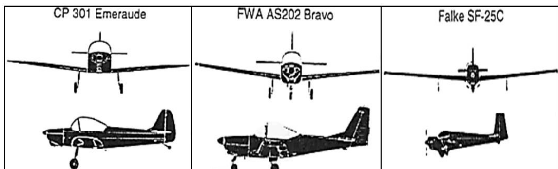
Figura 2 - Trem de pouso convencional, triciclo e biciclo com outriggers
