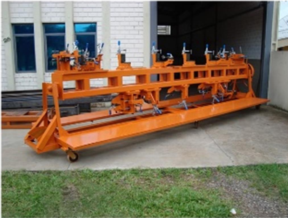
Figura 5 – Imagem de um dispositivo de solda
