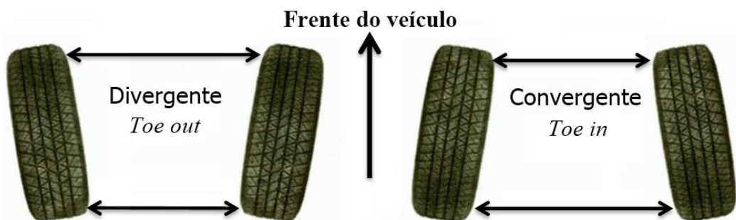
Figura 18 – Imagem representativa da convergência das rodas.
