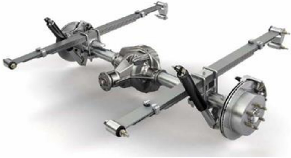
Figura 4 - Imagem de uma suspensão dependente.
