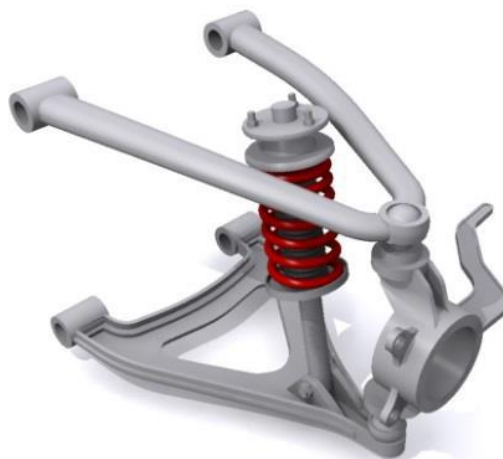
Figura 7 – Imagem de suspensão independente do tipo duplo-A.
