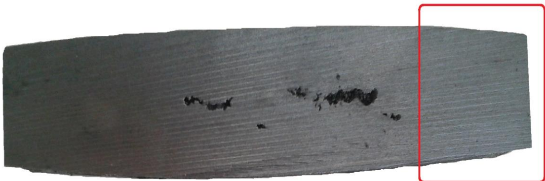
Figura 17 - Região aproveitada para os testes metalográficos circulado em vermelho
