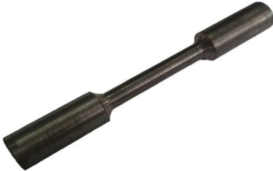
Figura 16 - Aparência do corpo de prova pronto para ensaio de tração
