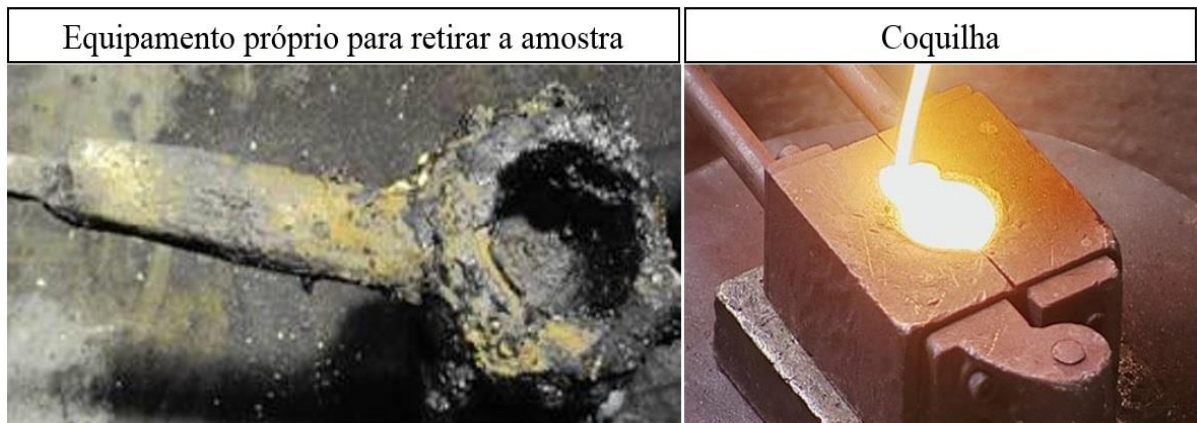
Figura 12 - Ferramentas para obtenção de amostras para análise química
