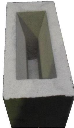
Figura 8 – Molde em areia branca confeccionado sob pressão para obtenção de blocos Y
