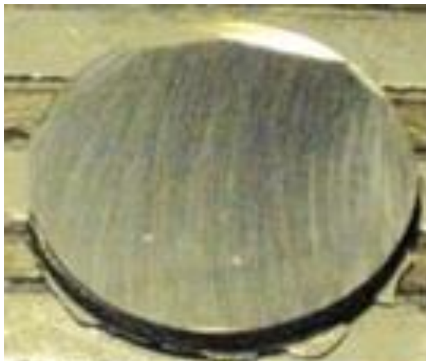
Figura 13 - Corpo de prova pronto para o ensaio químico
