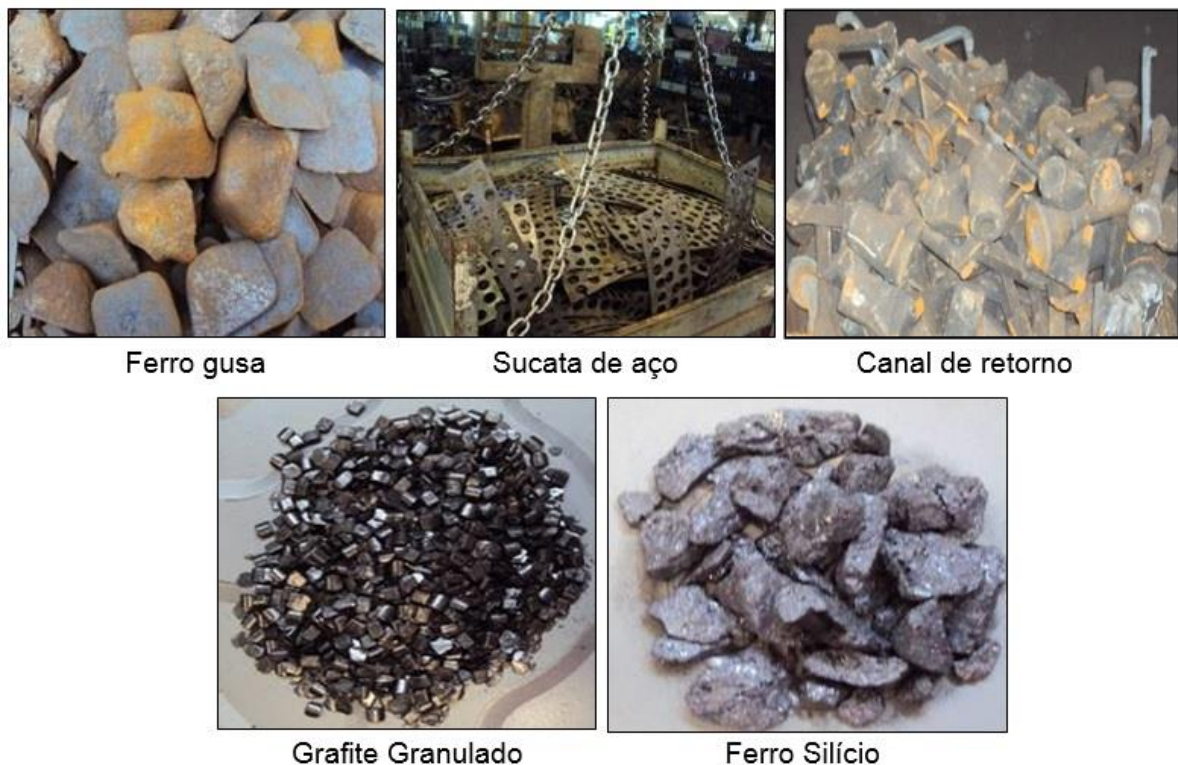
Figura 9 – Características visuais dos materiais que formaram a carga base
