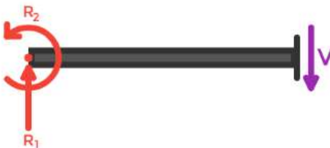
Figura 11: Esforço cortante da estrutura
