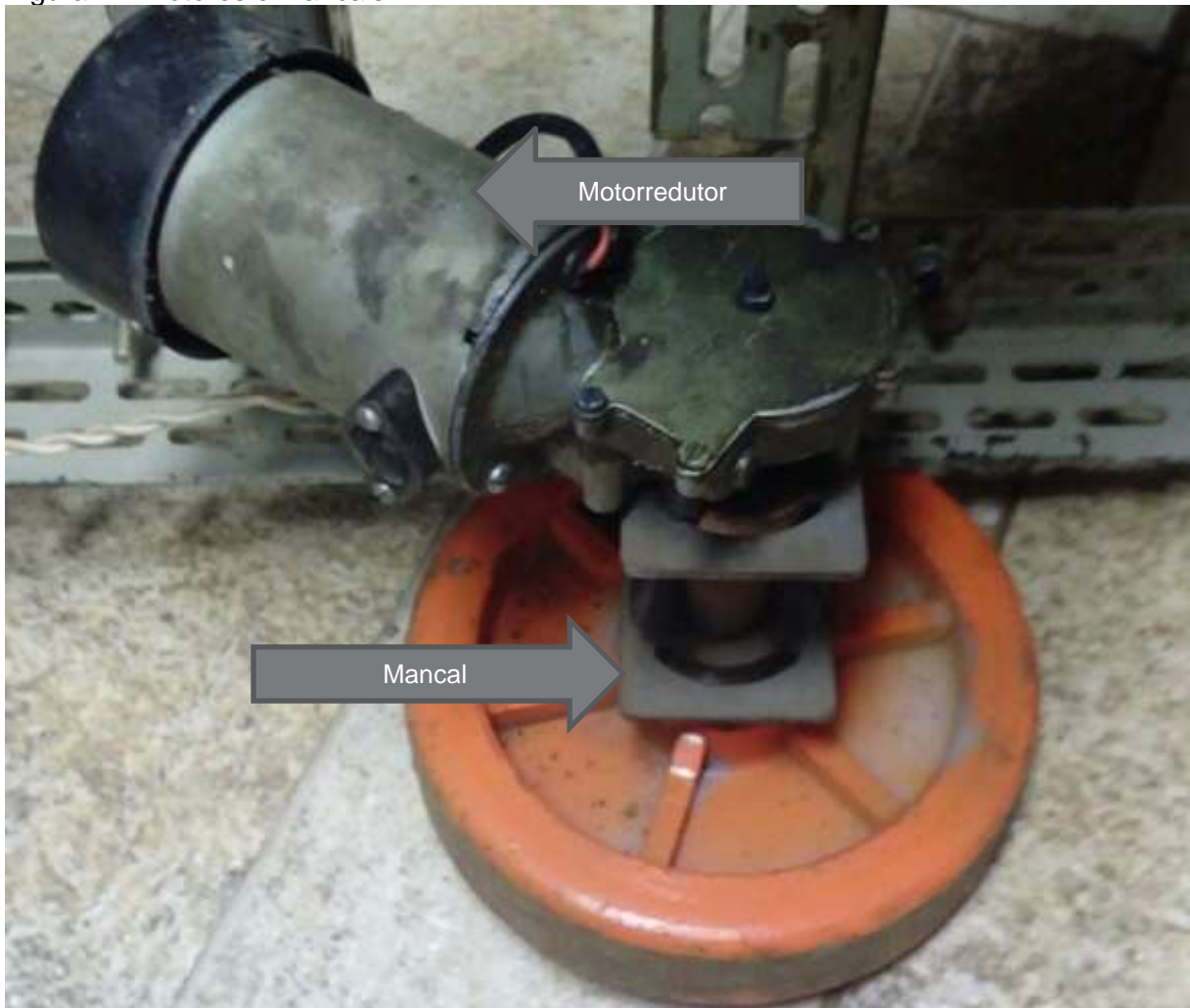
Figura 11: Motores e mancais
