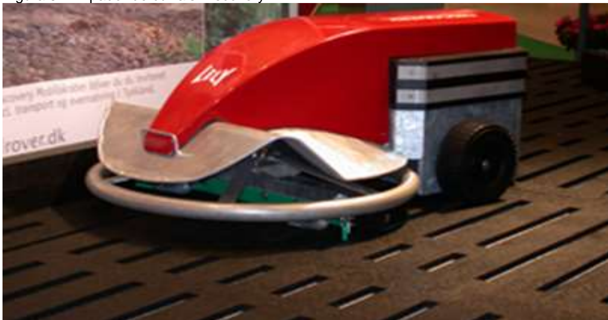
Figura 9: Limpador de currais Discovery
