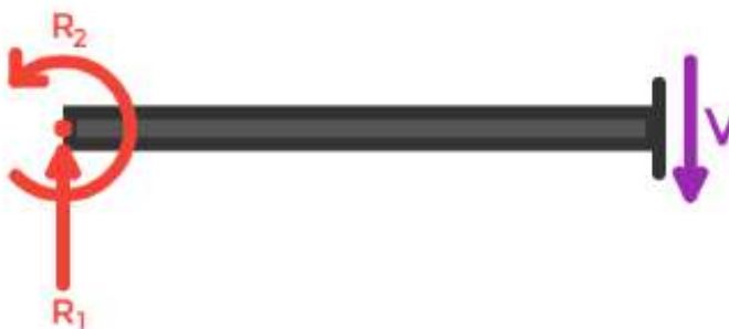
Figura 11: Esforço cortante da estrutura
