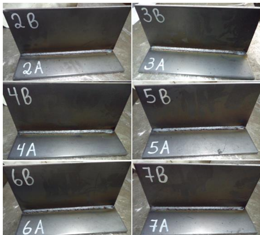
Figura 29: Amostras dispostas lado a lado para inspeção visual.
