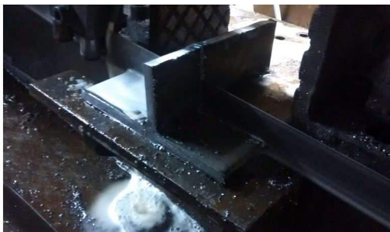
Figura 26: Serra fita em processo de corte da amostra.
