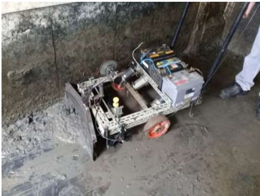
Figura 27 - Raspador removendo dejetos
