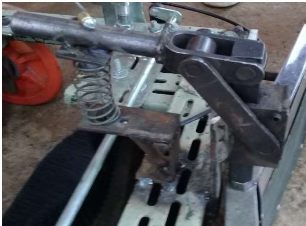
Figura 19 - Sistema de regulagem de altura do raspador
