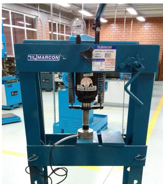
Figura 10 - Calibração da célula de carga.
