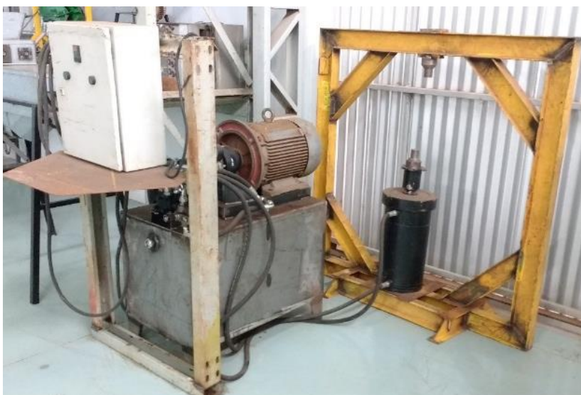
Figura 13 - Bancada hidráulica utilizada para o ensaio de flexão.
