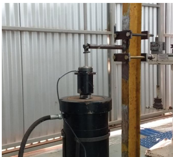
Figura 14- Sistema montado para o ensaio de flexão.
