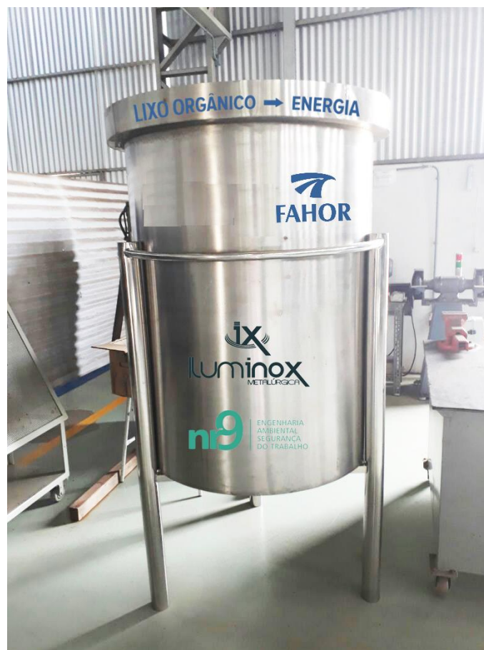
Figura 12: Tanque de digestão
