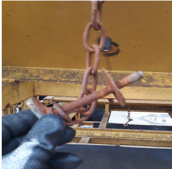
Figura 6 - Parafusos com Rosca Oxidada
