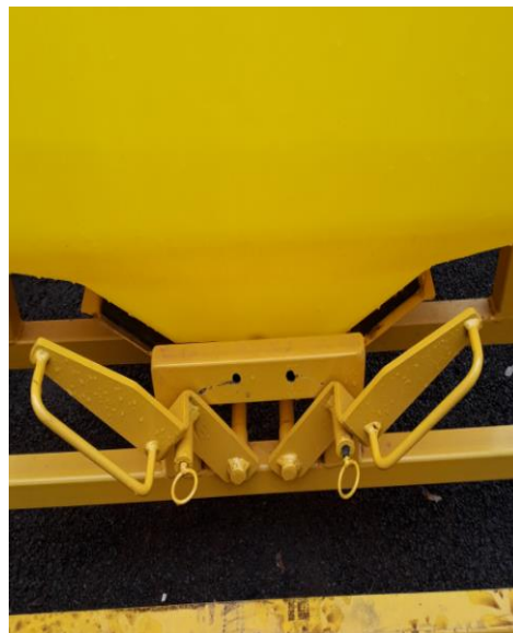
Figura 13 - Alavancas na Posição Fechada
