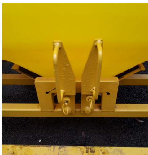
Figura 15 - Alavancas na Posição Aberta
