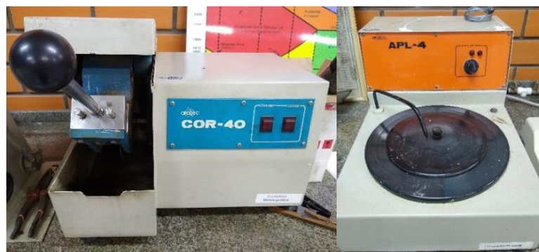
Figura 20 - Cortadora metalográfica (a) e máquina politriz (b).
