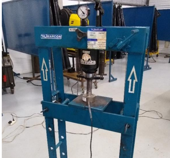
Figura 16 - Prensa hidráulica com manômetro
