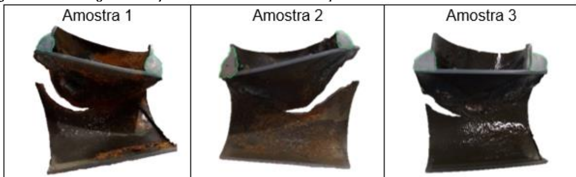
Figura 28 – Macrografia das juntas soldadas em "T" do aço SAE 4130.
