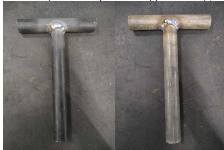
Figura 14 - Juntas soldadas de perfil "T" dos aços SAE 4130 (a) e SAE 1020 (b).
