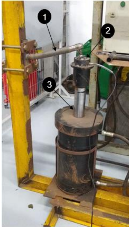
Figura 22 - Corpo de prova submetido ao ensaio de flexão
