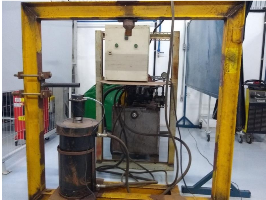
Figura 19 - Bancada hidráulica para o ensaio de flexão.
