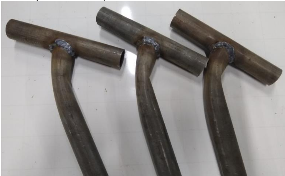
Figura 26 - Deformação dos tubos do aço 1020.
