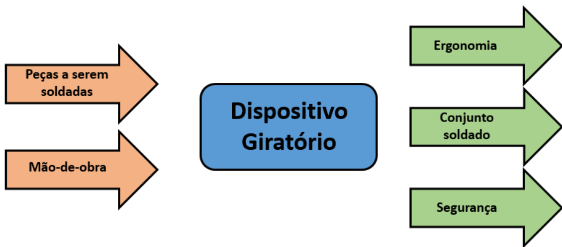
Figura 12 - Fluxograma da função global do dispositivo
