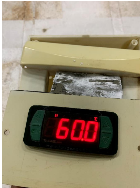
Figura 50 - Sensor de temperatura interna da estufa.
