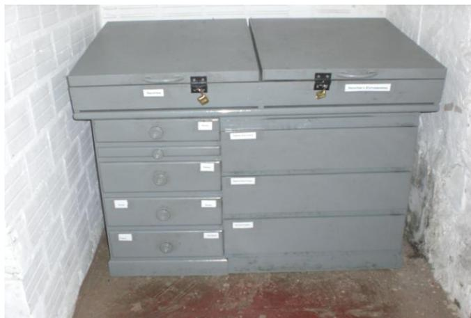
Figura 15: Box para depósito de insertos de usinagem após aplicação dos 5Ss. Fonte: Empresa pesquisada.
