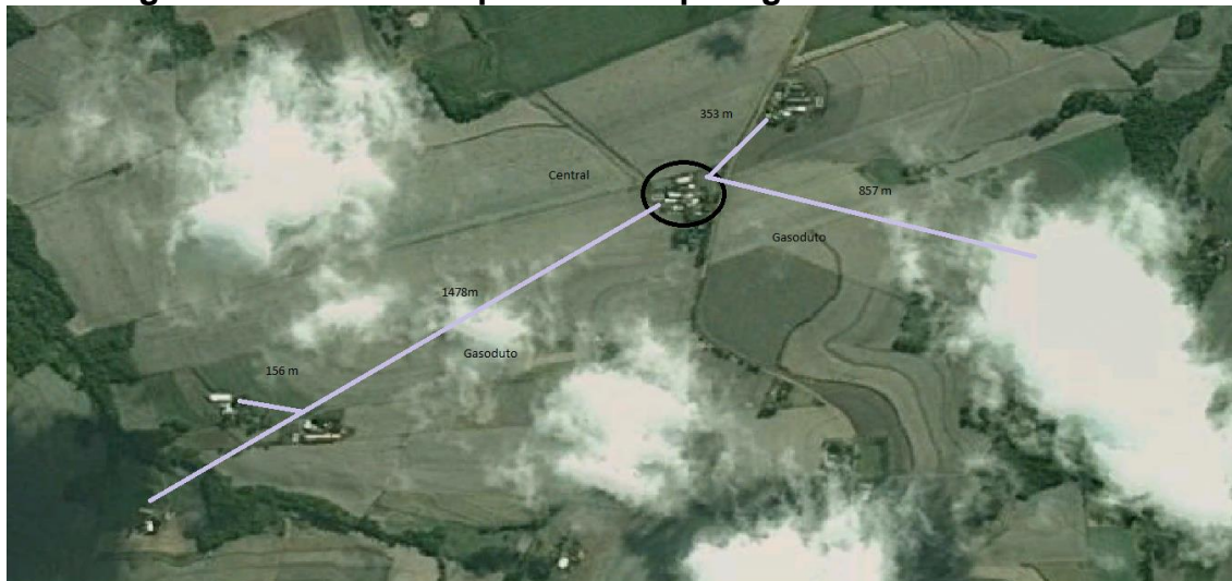
Figura 10 - Distâncias percorridas pelo gasoduto até a central.
