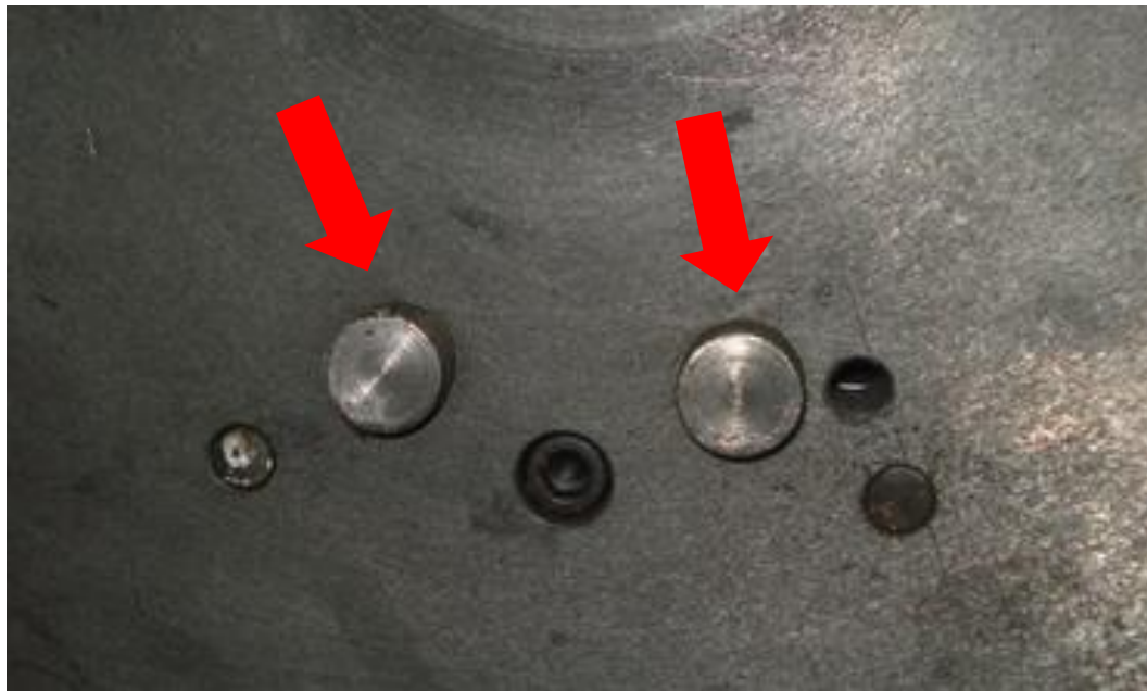
Figura 16 – Imagem dos guias para alinhamento de dispositivos.
