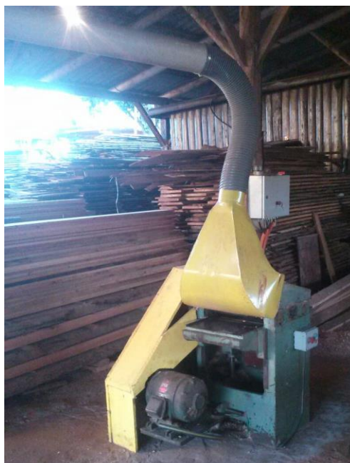
Figura 4 – Parte do sistema de ventilação exaustor que fica acoplado na plaina desengrossadeira.
