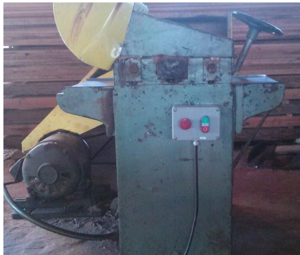
Figura 7 – Dispositivo de segurança para acionamentos, desacionamentos e paradas de emergência.
