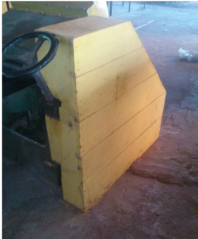
Figura 3 – Proteção de madeira nas partes móveis da plaina desengrossadeira.
