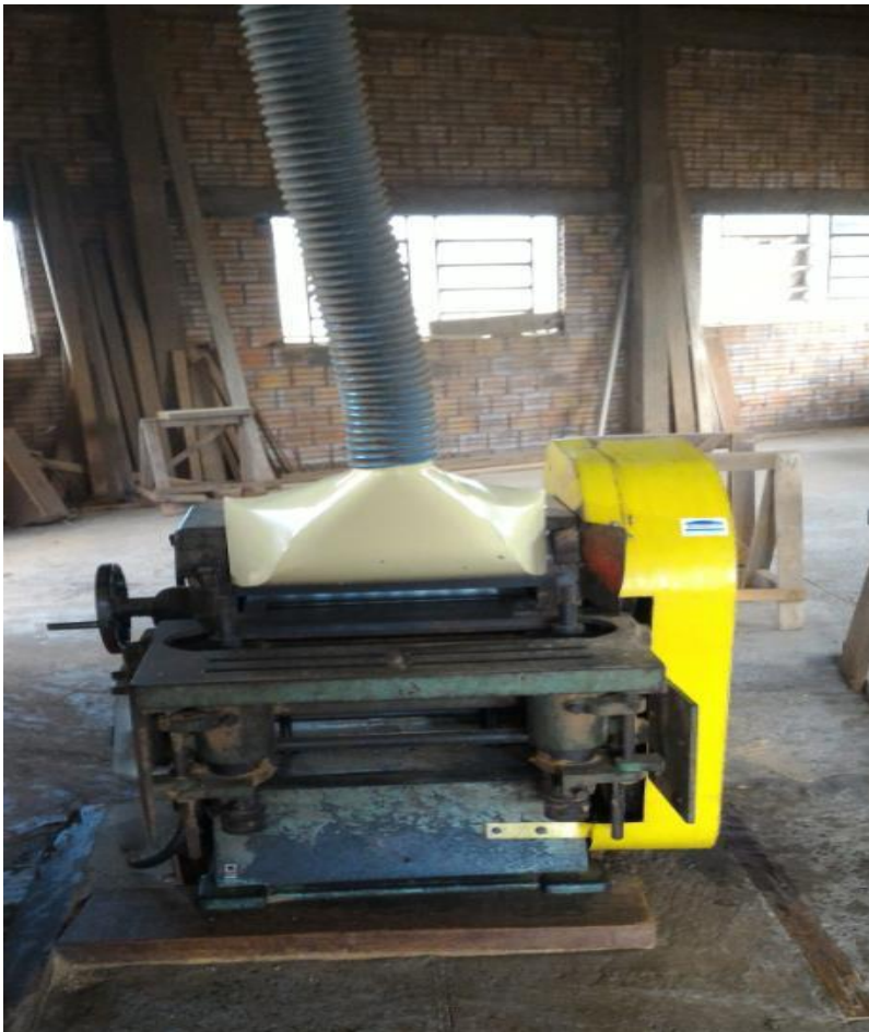
Figura 07 – Proteção nas partes móveis de metal da plaina desengrossadeira.
