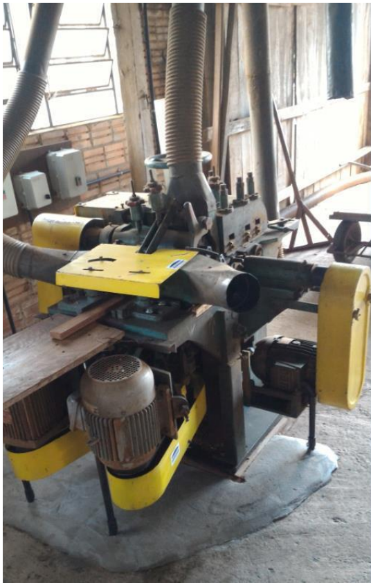
Figura 11 - Proteção nas partes móveis de metal da plaina moldureira.
