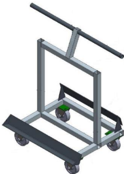
Figura 28: Carro kit para pagamento dos braços do rodado e suportes do cilindro
