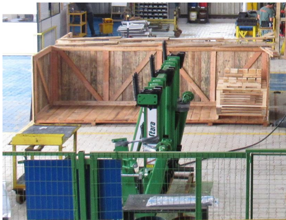
Figura 4: Embalagem de madeira dos subconjuntos e chassi principal
