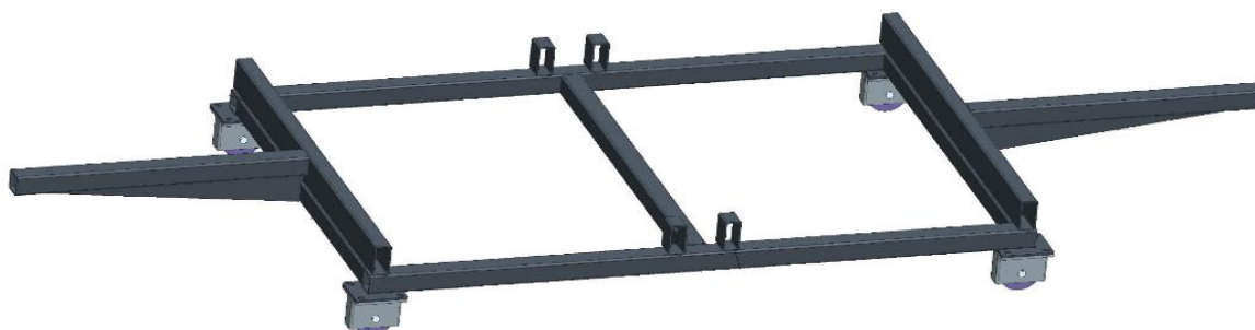
Figura 26: Carro de movimentação da embalagem de madeira nos trilhos
