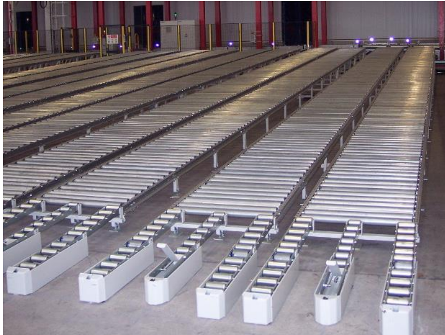
Figura 5 - Imagem de um sistema deslizante por gravidade
