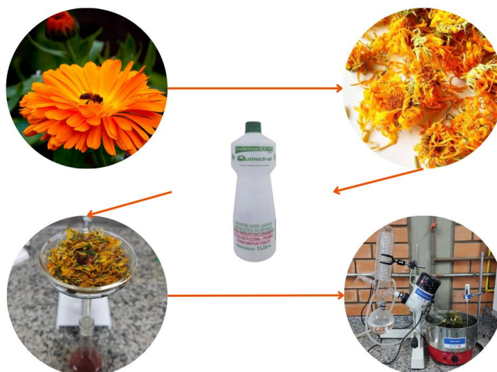
Figura 1: Etapas do processo de extração da calêndula utilizando álcool de cereais.
