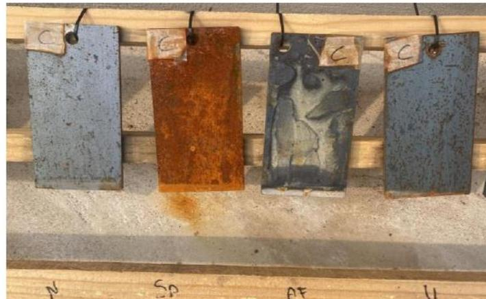
Na avaliação visual realizada no mês de outubro, que pode ser vista na Figura 12, novamente não se percebeu mudanças significativas nos corpos-testes com algum revestimento por pintura, mostrando a eficiência do revestimento contra a corrosão causada pelo intemperismo. Desta vez, notou - se um maior índice de corrosão nos corpos teste CN e CU, que antes não havia sido notado; nos corpos-testes CAF e CSA a corrosão seguiu aumentando.
