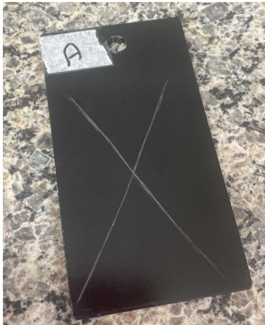
A névoa salina da câmara *salt spray* foi preparada com uma solução a 5% de NaCl. A temperatura foi regulada para 40 °C. Para este ensaio, foram utilizadas 6 corpos-teste preparadas com jateamento de granalha, aplicação de primer e pintura eletrostática a pó, 6 preparadas com jateamento de granalha e pintura eletrostática a pó e 6 sem nenhum tratamento ou pintura, que serviram como padrão de avaliação.
