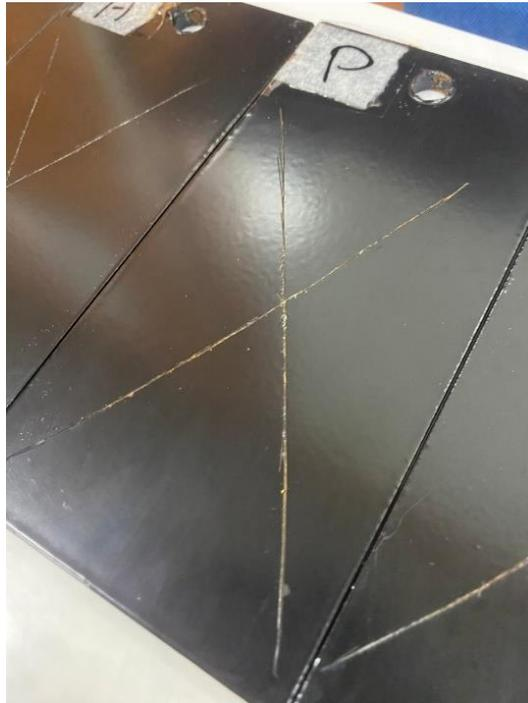
No ensaio utilizando ureia, os corpos-teste “P” também apresentaram corrosão, com indício de deslocamento próximo a incisão. Neste caso, os corpos-teste “A” também apresentam um grau de corrosão. Ambos os casos podem ser observados na Figura 9.
