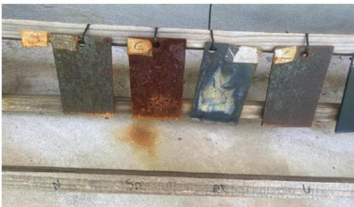
Antes do início da avaliação visual do mês de novembro, percebeu-se que os corpos-teste com revestimento não estavam apresentando mudanças, então foi feito cortes em forma de “X”, de modo que imitasse a erosão mecânica que é causada pelo atrito de grãos, que podem a vir a ser usados em maquinários agrícolas multiuso (fertilização e armazenamento de grãos). O corte foi superficial, de modo que só riscasse a película de tinta. Essa avaliação pode ser vista na Figura 13.
