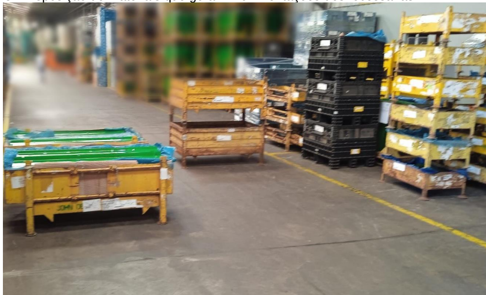
Figura 13 - Disposição de materiais que geram movimentações desnecessárias
