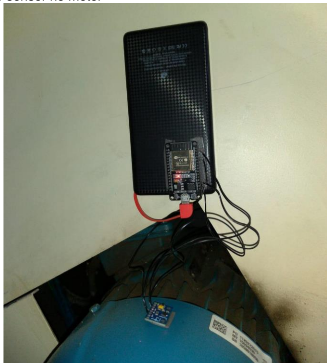
Figura 27 – Fixação do sensor no motor
