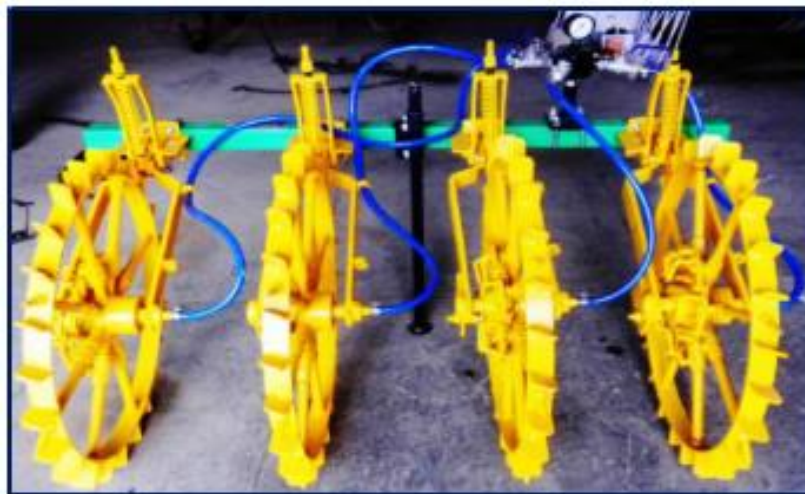
Figura 2 - Vista do projeto de um aplicador de nitrogênio
