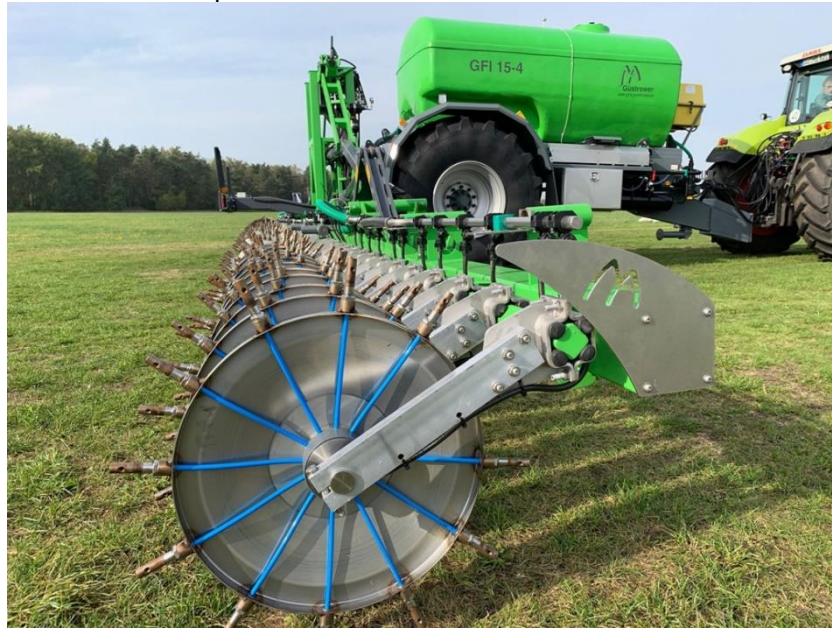
Figura 24 - Aplicador de adubo líquido
