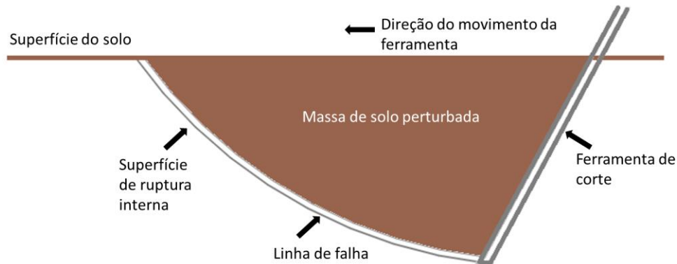
Figura 4 - Mecânica de corte e movimento do solo
