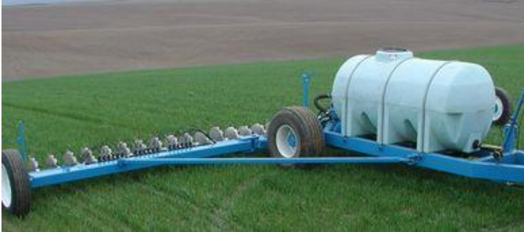
Figura 3 - Aplicador de fertilizante por puncionamento
