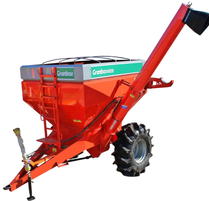
Figura 1 - Carreta graneleira com sistema de gravidade
