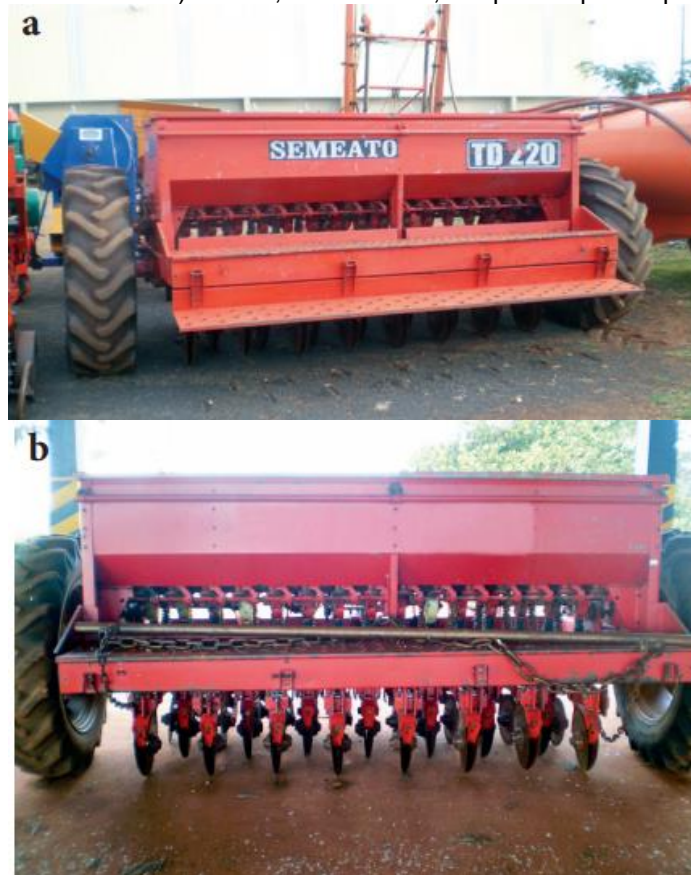
Figura 4 – a) Semeadora TD220 e b) TD300, da Semeato, adaptadas para o plantio direto
