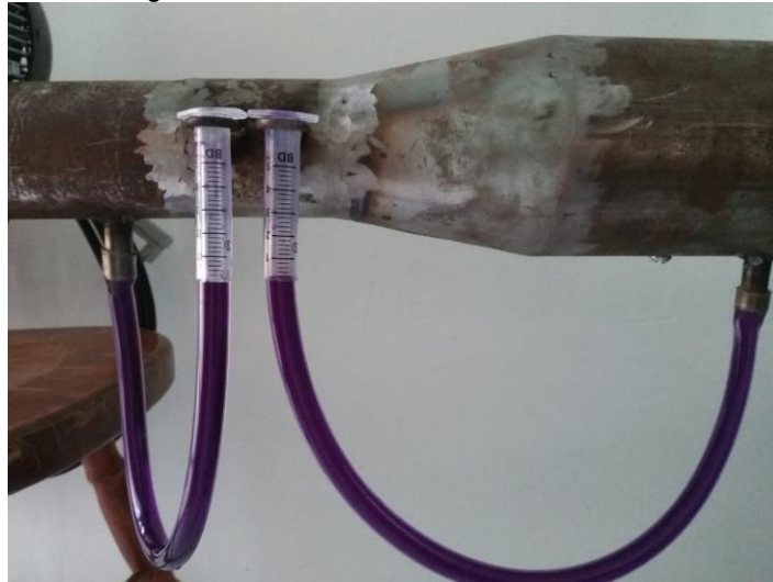
Figura 16: Mecanismo de Tubo de Venturi
