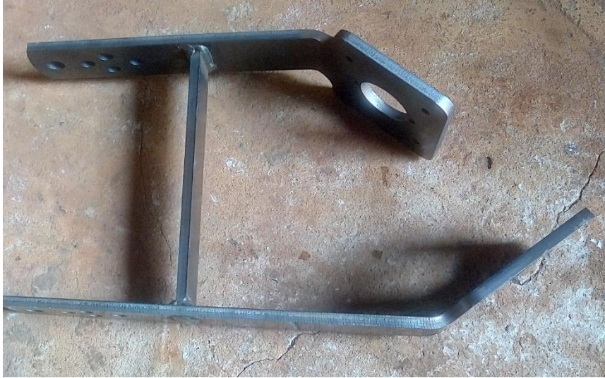
Figura 27 - Estrutura principal pós processo de solda
