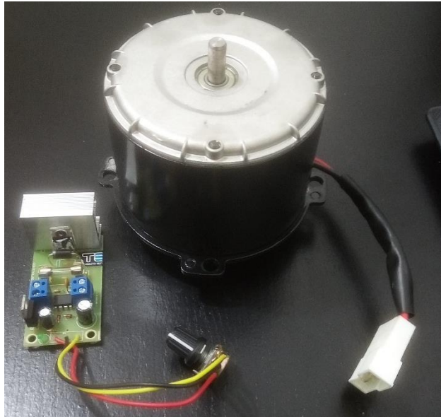
Figura 15 - Motor Imobras 101412412 + PWM 20A
